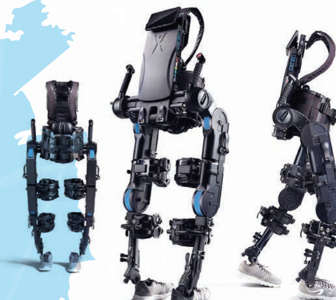
Экзоскелет EXOATLET – новейшая разработка роботизированной механотерапии, предназначенная для реабилитации людей с нарушениями работы ног
